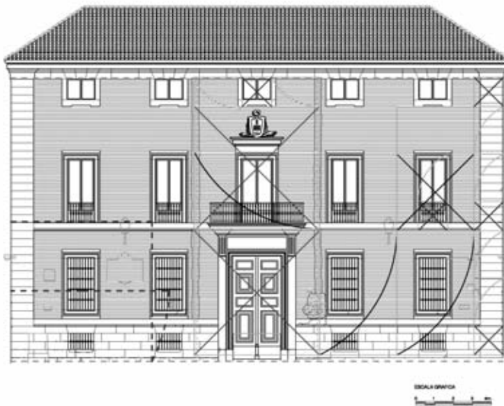
Edificio del nuevo rezado. Fachada oeste o principal, a la calle León. (nº 21). Arriba, modulación a base de la proporción cuadrada hasta cornisa y diagonal ( \sqrt{2} , \sqrt{3} ). Abajo, en base a la proporción cuadrada y a la diagonal.
